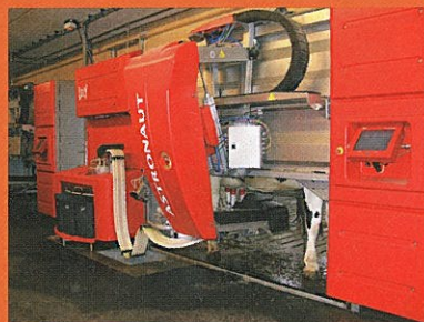
Der indsamles rutinemæssigt data fra Lely-malkerobotter, der registrerer mange forskellige typer data - eksempelvis mælkeflow og pattespidsernes placering.
